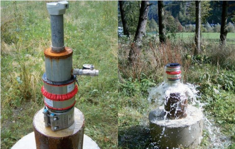
*Fig. 3: Artesische Grundwasserverhältnisse in der Bohrung W-KB12/08.
